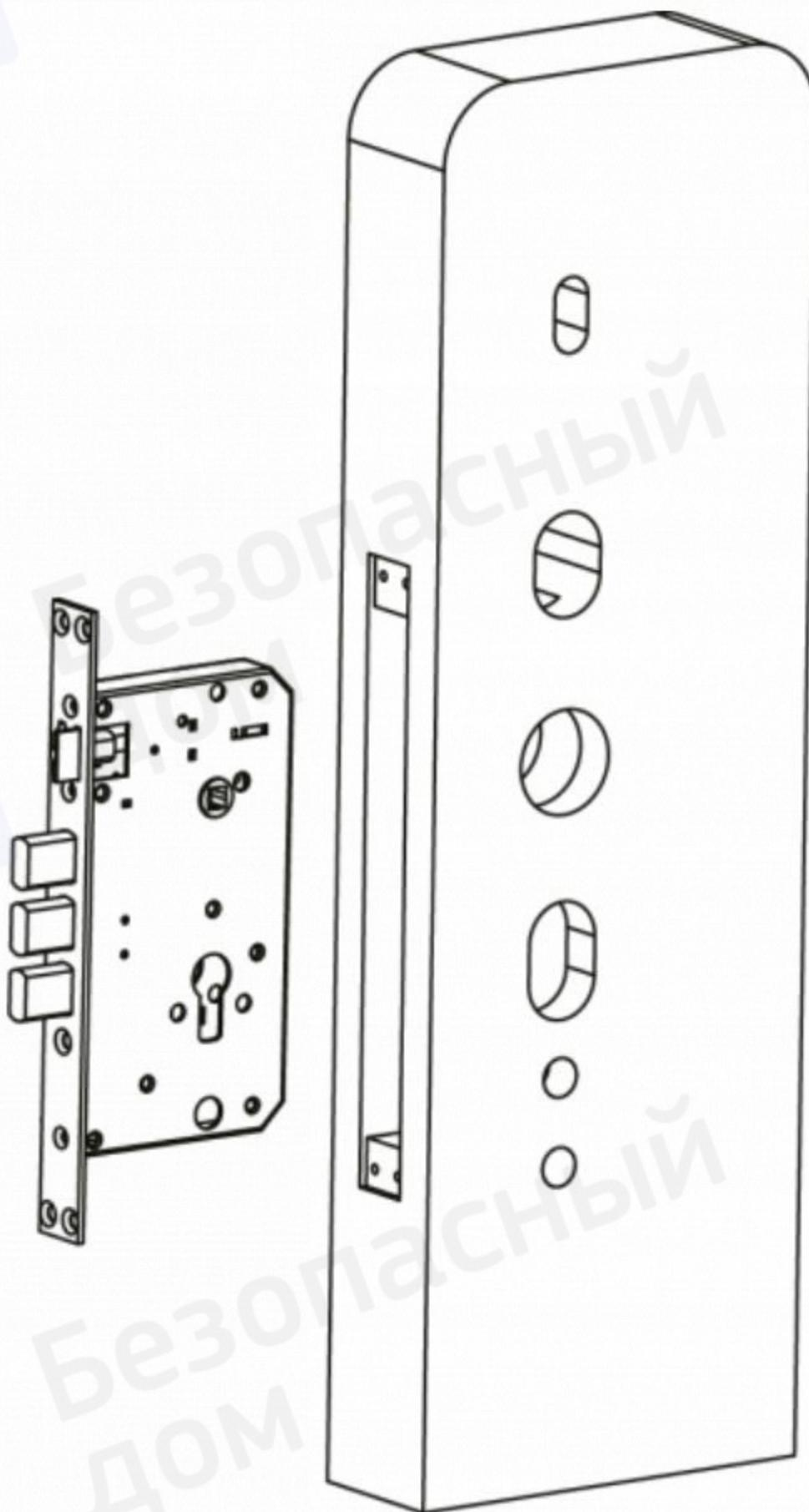
Установка врезной части замка
