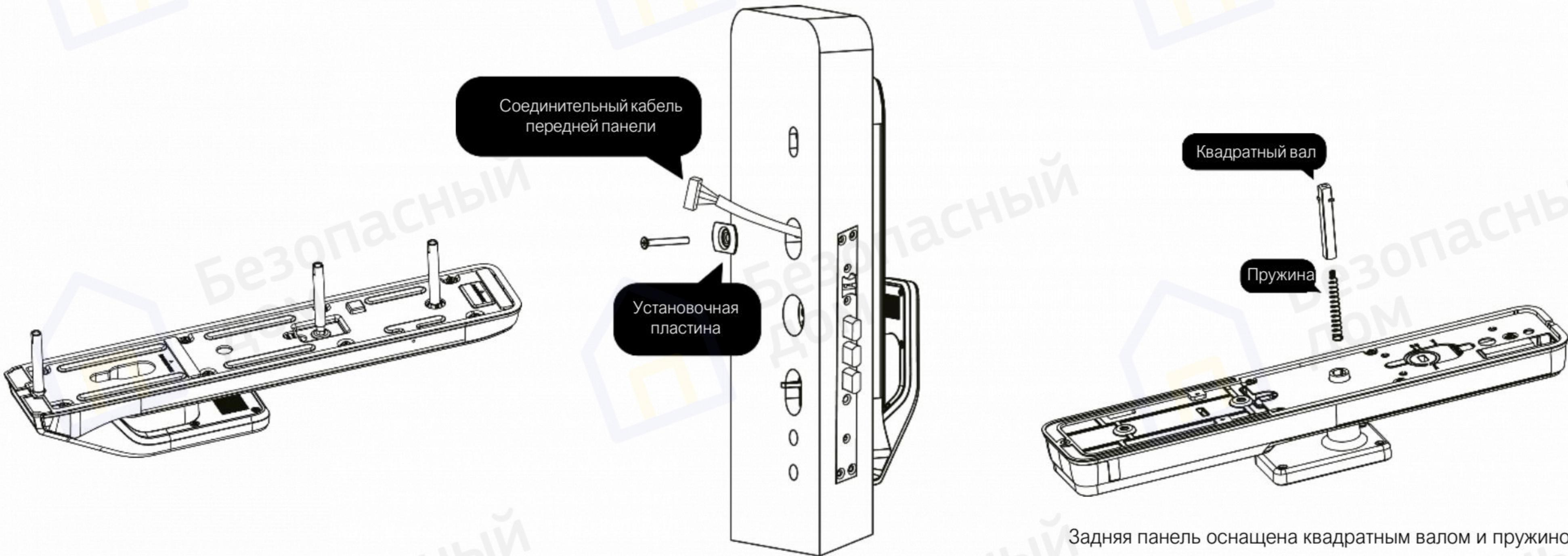
3 Пропустите соединительные кабели через отверстие в двери и соединительные винтовые болты, затем закрепите переднюю панель с помощью монтажной пластины.
